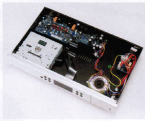
▲EVOLUTION 50CDは2系統のアナログ出力(RCA, XLR各1系統)と2系統のデジタル出力(RCA同軸, 光TOS各1系統)を装備。USB Bタイプを含め5系統のデジタル入力を持つ。ドライブメカはスロットインタイプを採用している
