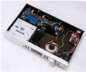
▲EVOLUTION 100CDはアナログ出力2系統(RCA, XLR各1系統)とデジタル出力2系統(RCA同軸, 光TOS各1系統)と50Aと同じ構成。デジタル入力は5系統のデジタル入力(USB Bタイプ, RCA同軸×2, 光TOS×2)。アナログ出力のRCA端子に、50Aよりもグレードの高いものが使われている
