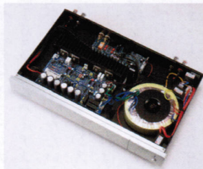
▲EVOLUTION 50Pの入力端子はRCAとXLR。プッシュボタンで切り換える。スピーカー出力は1系統。大型のトロイダルトランスが採用されている
